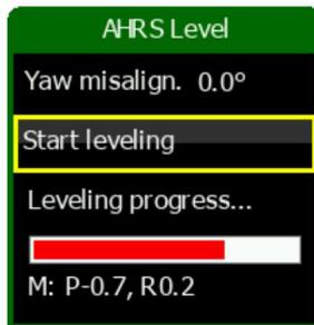
Abbildung 14: Darstellung des AHRS-Nivellierungsverfahrens.
