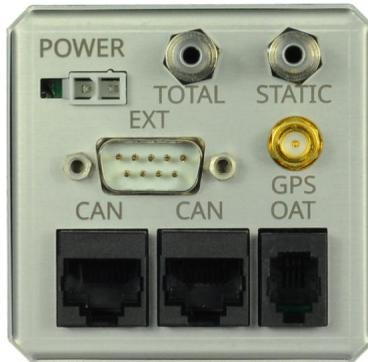
Abbildung 6: Rückansicht des Gerätes mit Anschlüssen. 57 mm Version ist gezeigt.
