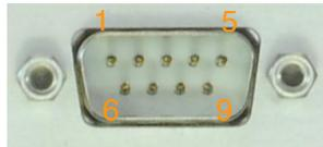
Abbildung 12: Darstellung der Pinbelegung am D-Sub-9-Anschluss.
