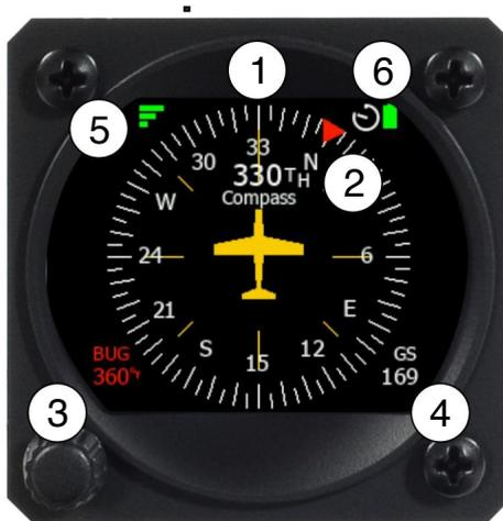
Abbildung 23: Fahrtrichtungsanzeiger-Bildschirm mit Markierungen.
