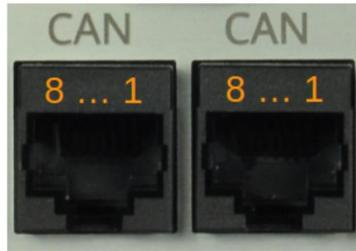
Abbildung 8: Darstellung der Pinbelegung der CAN-Ports.
