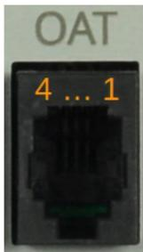
Abbildung 10: Pins des OAT-Anschlusses.
