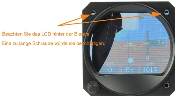
Abbildung 2: Beispiel eines defekten LCD-Bildschirms. Der Rand des LCD-Displays ist sichtbar hinter der Lünette.
