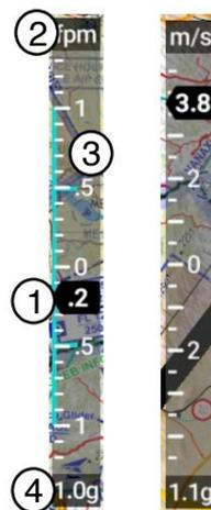
Abbildung 2.35: Darstellung der vertikalen Geschwindigkeitsanzeige. Links ist die Skala in ft/min
