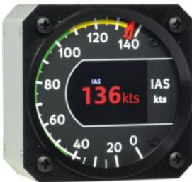
Dem Bus können ein oder mehrere Slave-Rundinstrumente (Indu genannt) hinzugefügt werden. Diese können nahezu jeden auf dem Bus verfügbaren Wert anzeigen. Die gängigsten sind: Fahrtmesser, Höhenmesser, Variometer, Triebwerksdrehzahl, Rotordrehzahl, G-Meter usw. Alle Anzeigen bestehen aus einer Nadel, die auf eine Skala zeigt, und einem LCD-Display. Der Zeiger wird von einem Schrittmotor angetrieben.
