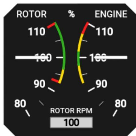
Abbildung 2.13: Die Kombination aus Rotordrehzahl und Motordrehzahl. Beide Skalen sind in Prozent angegeben.
