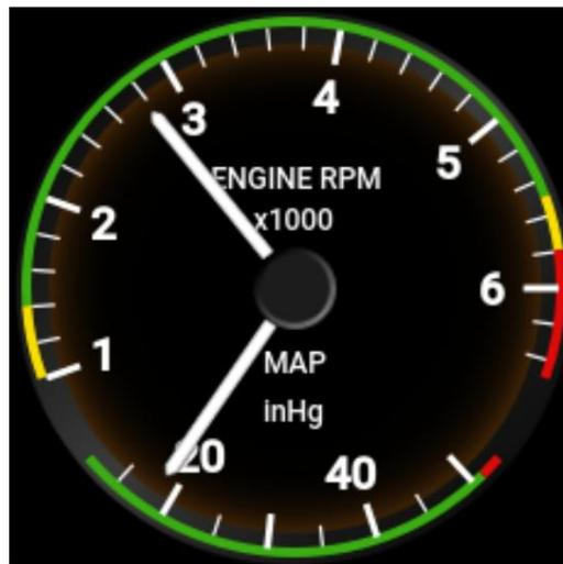
Abbildung 2.11: Die Kombination aus Drehzahl- und Saugrohrdruckanzeige.
