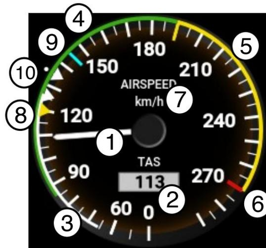
Abbildung 2.8: Beispiel eines für ein Flugzeug mit zweistufigen Landeklappen optimierten Fahrtmessers.
