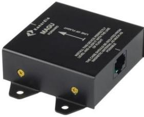
Der elektronische Kompass (Magu) ist ein eigenständiges Gerät zur Messung des Magnetfeldvektors. Er dient als kreiselstabilisierter Kompass und liefert hochpräzise die wahre und magnetische Richtung. Er verfügt über einen intelligenten Kalibrierungsalgorithmus, der nur eine bekannte magnetische Richtung zur Kalibrierung benötigt.
