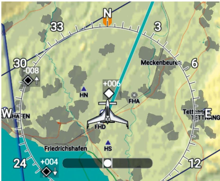
Abbildung 5.1: Trac-Symbole auf einer Karte. Der vertikale Unterschied wird in Hunderten von Fuß angegeben, da drei Ziffern verwendet werden.
