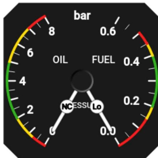
Abbildung 2.19: Runder Druckanzeiger mit speziellen Markierungen auf den Nadeln.
