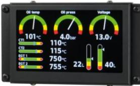
Zur Anzeige von Motorwerten wird typischerweise ein rechteckiges, sehr schlankes und sehr leichtes LCD-Display (Digi genannt) verwendet. Die Werte können in Form von Bögen, Balken, Kästchen und Werten angezeigt werden. Die Anzeige startet sehr schnell. Sie können den Öldruck fast sofort ablesen, während das Nesis-Hauptdisplay noch hochfährt.
