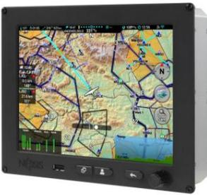
Das Slave-Nesis-Display kann dem System hinzugefügt werden. Es verfügt über die gleiche Funktionalität wie das Master-Nesis. Der einzige Unterschied besteht darin, dass es nicht die Airu-Einheit hostet und dass einige Systemoptimierungsoptionen nicht zugänglich sind.
