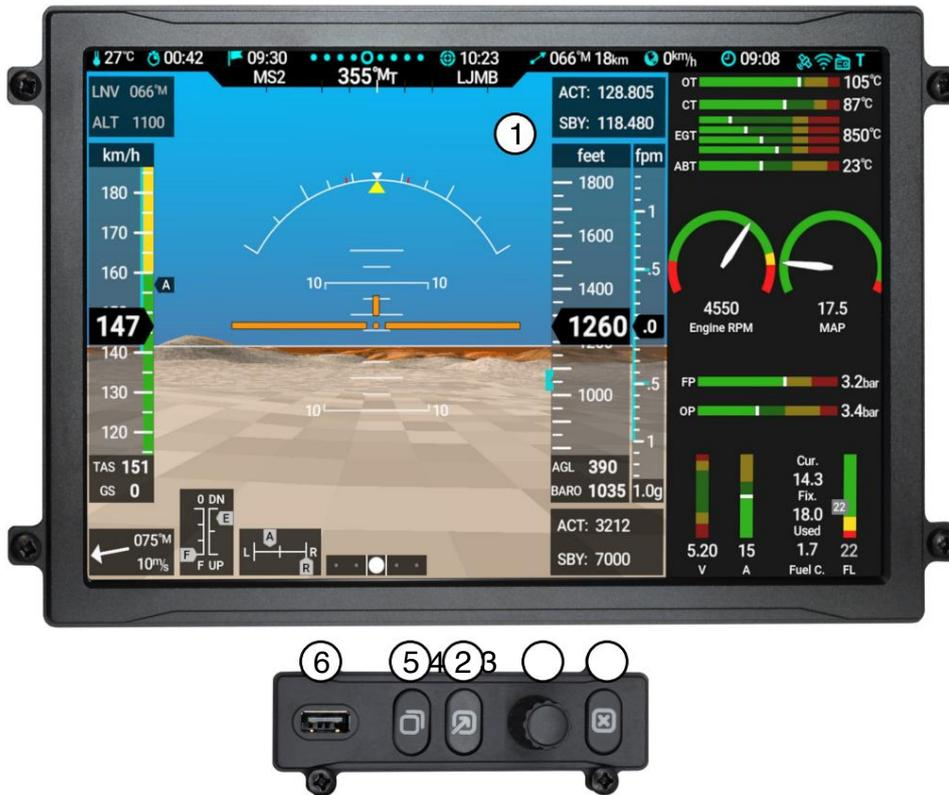
Abbildung 2.1: Nesis IV 10" Display-Aufbau. Ein separates Bedienfeld namens Kliky ist mit Nesis verbunden. Kliky ist separat montiert von Nesis in jeder Ausrichtung.
