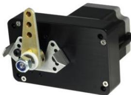
Wenn zwei Servoeinheiten (Seru genannt) zum CAN-Bus hinzugefügt werden, übernimmt das System auch die Autopilotfunktion. Seru II verfügt über eine integrierte Kupplung. Seru I hat keine Kupplung und ist in zwei Varianten erhältlich: Die stärkere und schwerere Variante hat ein Drehmoment von 6 Nm (53 in lb), die leichtere und schwächere Variante ein Drehmoment von 3 Nm (27 in lb). Seit 2025 liefern wir nur noch Seru II.
