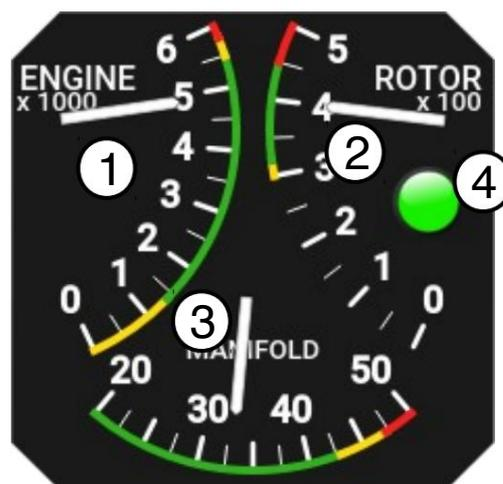
Abbildung 2.12: Vier in einem: die Kombination aus Motordrehzahl, Rotordrehzahl, Krümmerdruck und Vorrotationshilfslampe.
