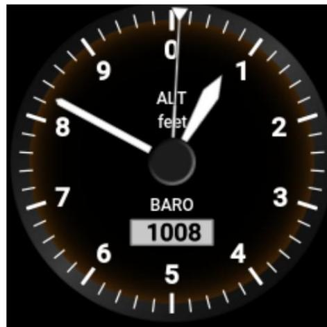
Abbildung 2.10: Die Höhenanzeige mit der Skala in Fuß. Drei Zeiger werden in diesem Fall angezeigt.
