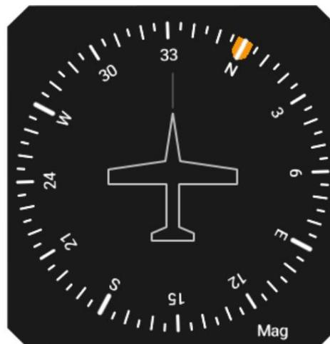
Abbildung 2.17: Darstellung des Fahrtrichtungsanzeigers.
